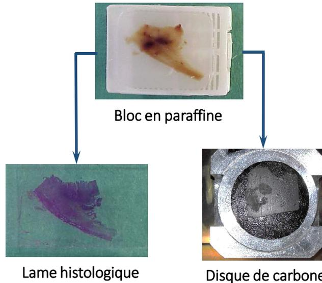
Une coupe est destinée à la microscopie optique et l'autre à la microscopie électronique à balayage (MEB) et microanalyse (dépôt sur un disque de carbone).
