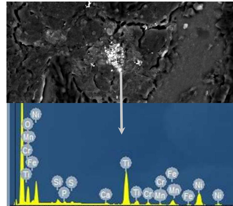
MEB sur 3 champs avec analyse chimique des particules *in situ* avec respect des structures tissulaires.
