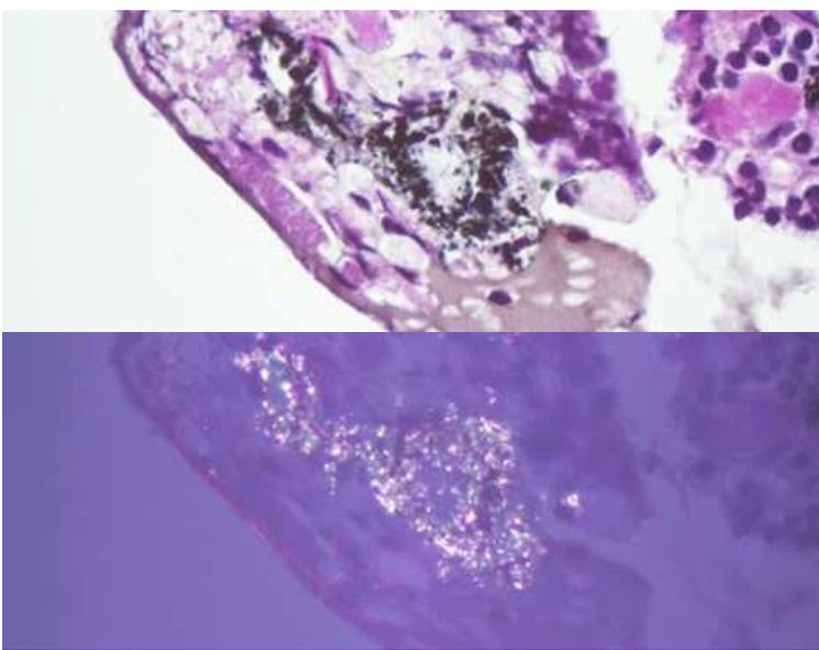
La microscopie optique sur lames permet l'observation de particules inorganiques.
